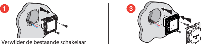
Verwijder de bestaande schakelaar
