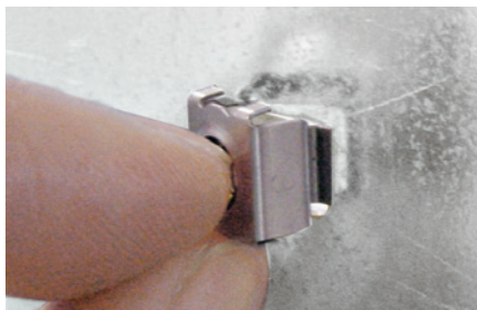
Mise en place des écrous-cage, par l'arrière de la platine métallique.
