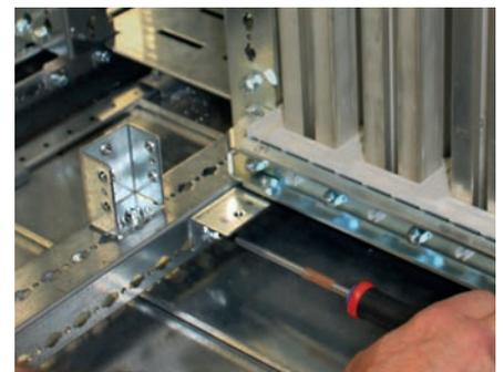
Fixer également les deux équerres pour les plaques de fermeture haute ou basse à 325 mm de la face avant.
