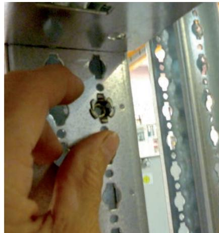
Pour fixer le kit à l'arrière du châssis il faut d'abord mettre en place les deux clips-écrous.
