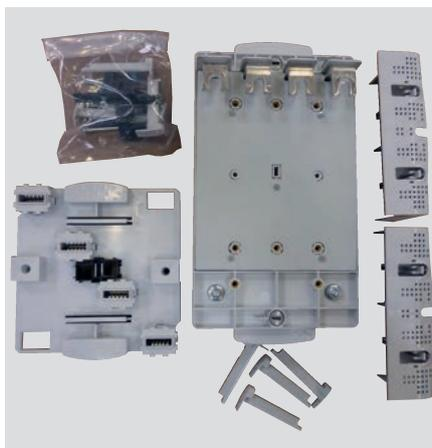
Les bases supports pour DPX<sup>3</sup> sont composées d'une partie fixe, d'une partie mobile, d'un kit anti-extraction et de deux cache-bornes. Elles permettent la connexion automatique d'un DPX<sup>3</sup> 160 ou 250 (hors charge) sur le répartiteur de rangée en présence de tension.
