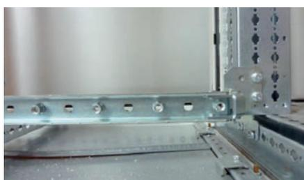
Le support d'extrémité inférieur est fixé à l'arrière de la partie basse des montants fonctionnels (utilisation des deux premiers trous).
