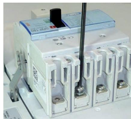
Serrer les connexions électriques amont grâce aux quatre (pour le 4P, 3 pour le 3P) vis fournies avec la base (couple de serrage : 8N·m -> DPX<sup>3</sup> 160 ; 10N·m -> DPX<sup>3</sup> 250 ; 24N·m -> DPX<sup>3</sup> 630).
