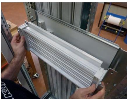
Insérer la partie mobile sur la partie fixe grâce aux tiges de guidage.
