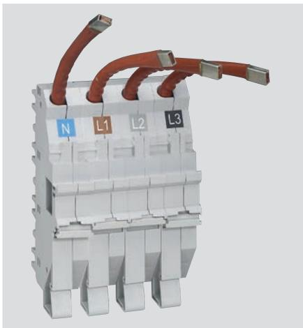
Avec les bases à fils, l'ordre de montage est différent des bases plug-in. Pour prévenir tout risque de contact avec des parties sous tension, les fils doivent être connectés au disjoncteur avant l'installation de la base sur le répartiteur.
