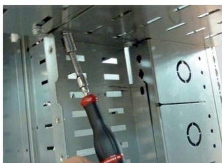
Insérer le kit dans la fente du cloisonnement latéral du châssis puis le fixer à l'aide des six vis fournies.
