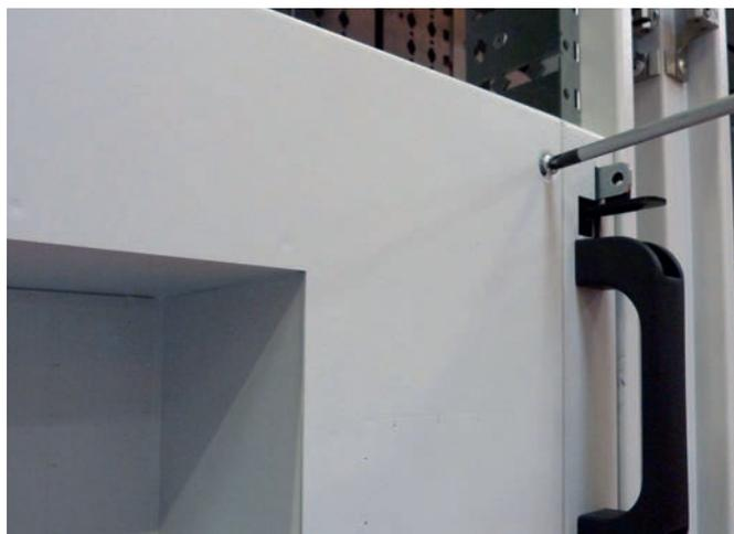
La fixation du plastron s'effectue à l'aide des quatre vis fournies.
