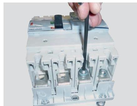
Réaliser les connexions électriques amont avec les vis fournies avec le disjoncteur (clé Allen de 4, couple de serrage de 7 N·m).
