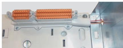
Refixer le module de raccordement des circuits auxiliaires sur la base.
