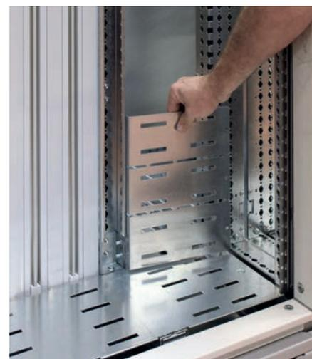
Pour obtenir le niveau de forme 3b, la partie du châssis IS qui ne sera pas équipée de base VX<sup>3</sup> IS doit être fermée en face avant par les cloisons de réserve de hauteur 300 mm réf. 4 046 89. Elles peuvent être recoupées si besoin au pas de 100 mm.
