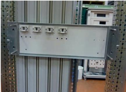
Le positionnement se fait sur le même principe que pour une platine standard XL<sup>3</sup> grâce aux ergots qui s'accrochent sur les montants fonctionnels.
