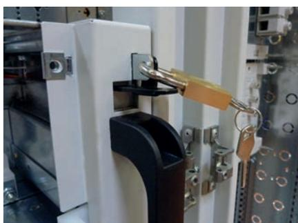
La condamnation du tiroir dans chacune des trois positions est possible avec un cadenas ordinaire diamètre maxi 5 mm (par exemple réf. 4 063 13) inséré au niveau du levier de verrouillage. Un emplacement est disponible sur chacun des deux leviers.
