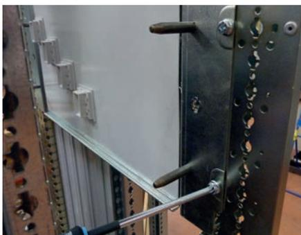
Positionner la partie fixe et la fixer sur les montants fonctionnels du châssis IS.
