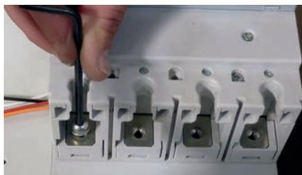
Serrer les connexions électriques amont et aval grâce aux huit (ou six) vis fournies avec la base (couple de serrage : 8N·m -> DPX<sup>3</sup> 160 ; 10N·m -> DPX<sup>3</sup> 250 ; 24N·m -> DPX<sup>3</sup> 630).
