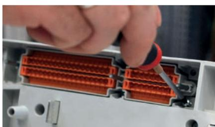
Pour la partie mobile, la partie femelle du module de raccordement est fixée par l'arrière à l'aide de six petites vis (couple de serrage 2,5 N·m).
