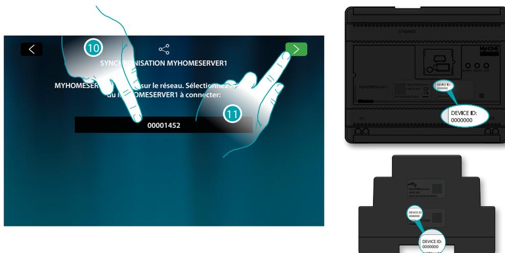
10. Sélectionner le MyHOMEServer1 en l'identifiant avec le DEVICE ID (ID dispositif) présent sur la partie frontale ou latérale du dispositif.
