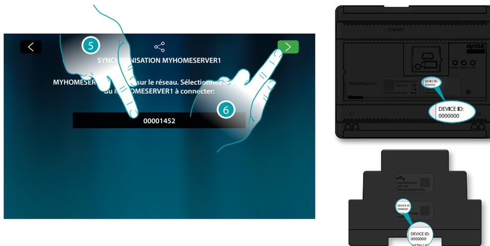
5. Sélectionner le MyHOMEServer1 en l'identifiant avec le DEVICE ID (ID dispositif) présent sur la partie frontale ou latérale du dispositif.
