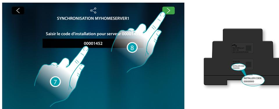
7. Saisir l'INSTALLER CODE (Code Installateur) présent sur la partie latérale du dispositif.
