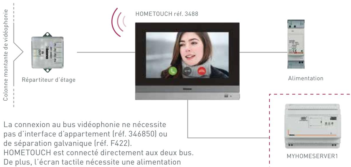
La connexion au bus vidéophonie ne nécessite pas d'interface d'appartement (réf. 346850) ou de séparation galvanique (réf. F422). HOMETOUCH est connecté directement aux deux bus. De plus, l'écran tactile nécessite une alimentation supplémentaire (réf. 346020).
