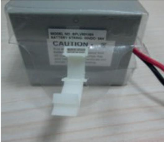
**FR** – Assembler le support connecteur sur le pack batterie.
