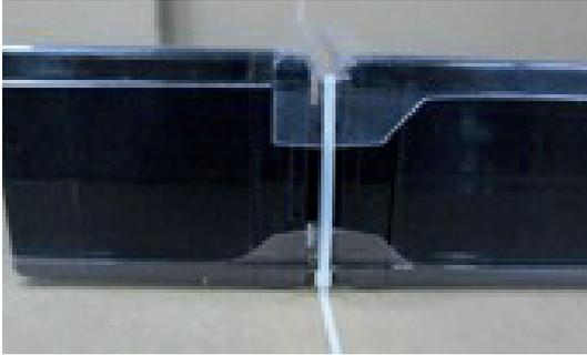
**FR** – Fixer le pack batterie avec deux fixations de câble aux extrémités.
