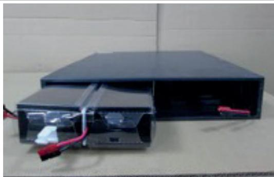
**FR** – Introduire les packs batteries dans l'armoire et brancher les connecteurs de batterie.
