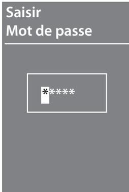
Le mot de passe permet à l'installateur d'accéder au menu Configuration ; par défaut, le mot de passe est réglé sur 00000 ; il est recommandé de le personnaliser pour prévenir les accès indésirables.
