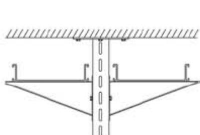
Au delà de 67 daN mesuré sur un même côté, répartition des charges de chaque côté du pendard jusqu'à 310 daN maxi
