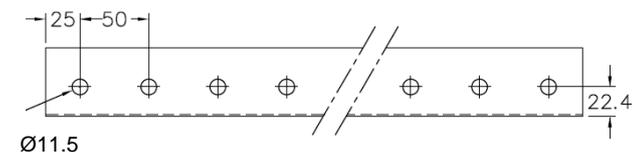
Pour la fixation des rails sur les goussets ; utiliser des vis M8x20
