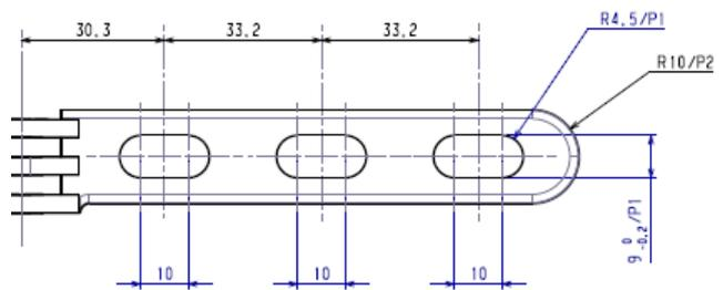
Fixation avec boulon M8 ; trous oblongs 9x18mm, entraxe 33.2mm
