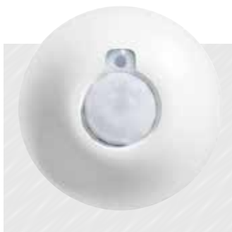
REF. 048922 PIR-detectie 360° Bereik 8 m IP 20 Montage aan het plafond
