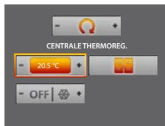
Il est possible de sélectionner la modalité manuelle et de régler la température à l'aide des touches - et + .
