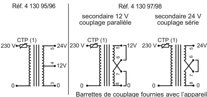
b. Transformateurs de sonnerie : transformateurs de sécurité dont la tension secondaire nominale ne dépasse pas 24 V et prévus pour une utilisation intermittente.
