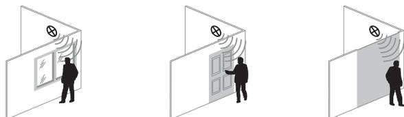
**ATTENTION** : L'appareil peut détecter des mouvements à travers une porte, une vitre et une paroi de faible épaisseur.
