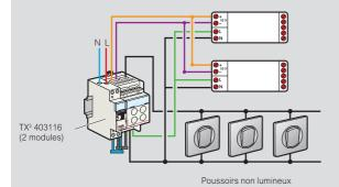
Télévariateur 1 000 VA pour sources lumineuses à ballast 1-10 V réf. 003660
