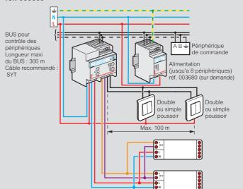
Télévariateur 1000 VA pour lampes incandescentes, halogènes, halogènes TBT à transformateurs ferromagnétiques ou électroniques réf. 003671
