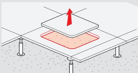
Faites une découpe dans le plancher technique (262x262mm)
