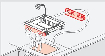
Installez le couvercle pré-câblé dans la dalle de sol (Boîtiers d'isolation inclus)
